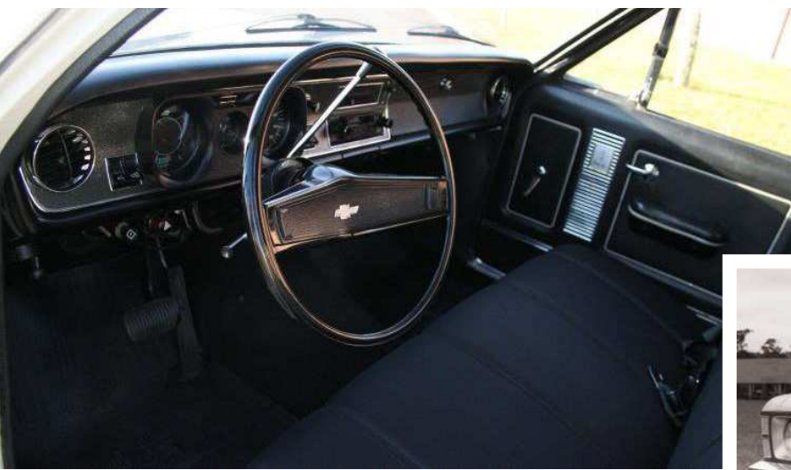
BANCO DIANTEIRO INTEIRIÇO E ALAVANCA DE CÂMBIO NA COLUNA DE DIREÇÃO
