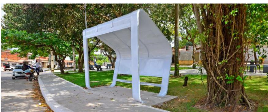
pas metálicas, aberturas laterais para ventilação e assento com chapa inox e inclinação na frente para melhor proteger os usuários. Os abrigos são adaptados para pessoas com pouca mobi-
