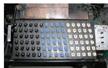
Teclado da Linotipo diferente dos atuais teclados dos computadores.
