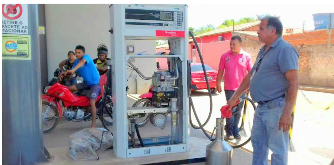
Fiscais do Inmeq-MA fazem verificação de bombas de combustível nos postos em Timon
